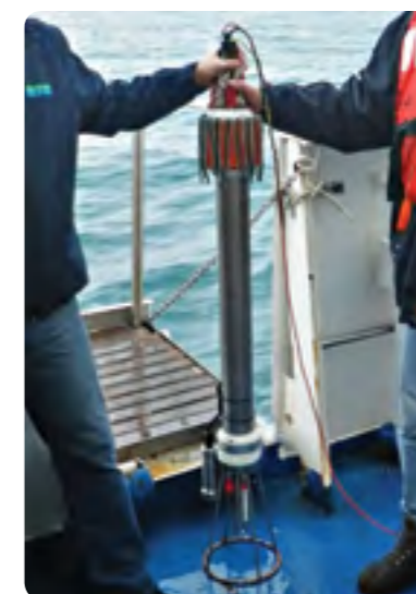
Multiparametrična sonda »Sea&Sun« CTD probe »Sea&Sun«
