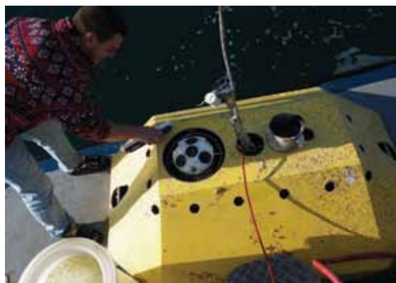
Po nekaj tednih meritev je merilnik tokov spet na krovu. (foto: T. Makovec) After weeks lying at the sea bottom, the currentmeter is back on board. (photo: T. Makovec)
