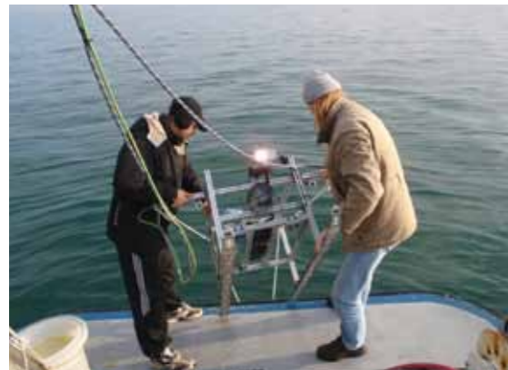
Spuščanje videosani za snemanje epibentosa (foto: M. Orlando Bonaca) Deployment of video-sledges for filming of epibenthos (photo: M. Orlando Bonaca)
