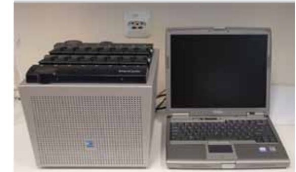
Prenosna aparatura za PCR v realnem času (Cepheid Smart Cycler) / Portable real-time PCR instrument (Cepheid Smart Cycler)
