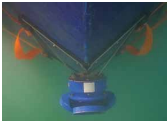
Merilnik tokov nameščen pod trup plovila. (foto: T. Makovec) Curentmeter placed at the bottom of the hull. (photo: T. Makovec)
