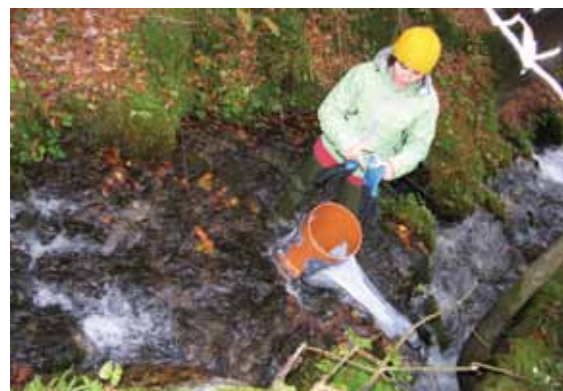
Vzorčenje favne v povirnih delih vodotokov s Hessovim vzorčevalnikom. (foto: N. Mori) Sampling of headwater benthic fauna with Hess sampler. (photo: N. Mori)
